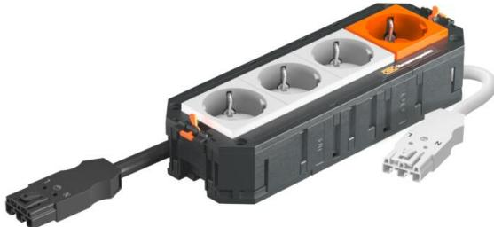
Der anschlussfertige Universalträger UTC4 verfügt über 3 vorinstallierte 33°-Schutzkontaktsteckdosen in weiß und eine vorinstallierte 33°-Schutzkontaktsteckdose in orange (mit Überspannungsschutzmodul Typ 3 nach DIN EN 61643-11), 250 V~ 16 A. Passend zu den Verbindungsleitungen VL und den Geräteeinbaeinheiten der Nenngröße R7, R9 und 9.
