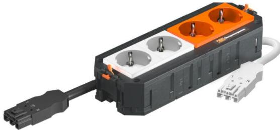
Der anschlussfertige Universalträger UTC4 verfügt über 2 vorinstallierte 33°-Schutzkontaktsteckdosen in weiß und über 2 vorinstallierte 33°-Schutzkontaktsteckdosen in orange (mit Überspannungsschutzmodul Typ 3 nach DIN EN 61643-11), 250 V~ 16 A. Passend zu den Verbindungsleitungen VL und den Geräteeinbaeinheiten der Nenngroße R7, R9 und 9.
