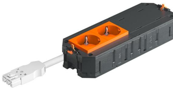
Der anschlussfertige Universalträger UTC4 verfügt über 2 vorinstallierte 33°-Schutzkontaktsteckdosen mit 16 A und 2 Blindabdeckung für den nachträglichen Einbau von 2 Installationsgeräten der Modul45. Passend zu den Verbindungsleitungen VL und den Geräteeinbaeinheiten der Nenngroße R7, R9 und 9.
