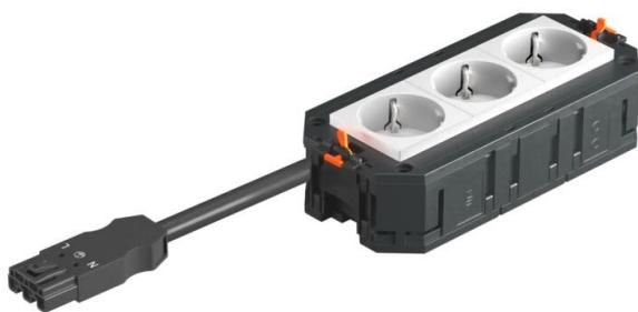
Der anschlussfertige Universalträger UTC3 verfügt über 3 vorinstallierte 33°-Schutzkontaktsteckdosen in weiß mit 16 A. Passend zu den Verbindungsleitungen VL und den Geräteeinbaeinheiten der Nenngröße 2, 4, R4, 6 und R7.
