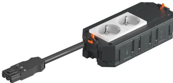
Der anschlussfertige Universalträger UTC3 verfügt über 2 vorinstallierte 33°-Schutzkontaktsteckdosen in weiß mit 16 A und eine Blindabdeckung für den nachträglichen Einbau von einem Installationsgerät der Modul45- oder Modul 45connect-Serie. Passend zu den Verbindungsleitungen VL und den Geräteeinbaueinheiten der Nenngröße 2, 4, R4, 6 und R7.
