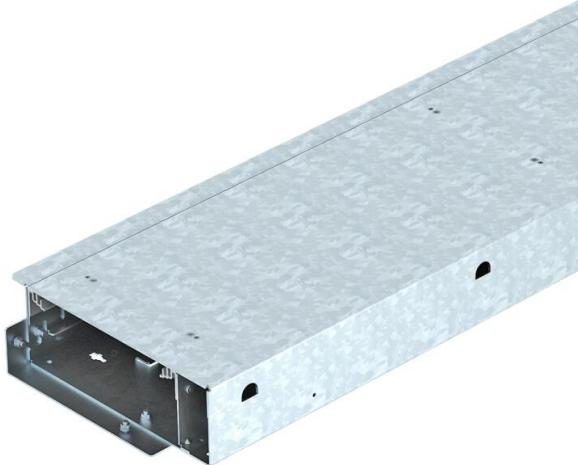
Montagefertige Kanaleinheit zur Leitungsführung und zum Geräteeinbau, bestehend aus einem Kanalunterteil mit zwei Blinddeckeln. Im Lieferumfang enthalten sind zwei Deckelstoßdichtungen und ein Verbinder. Zur Höheneinstellung werden sechs Nivelliereinheiten benötigt. Bis maximal 5 kN belastbar. Die Kanaleinheit kann mit ein verstellbaren Bodenbelagsanlegeprofil zur Estrichabgrenzung in Bereichen von Türläubungen und vor Heizkörpernischen ergänzt werden.
