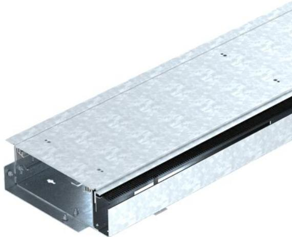
Montagefertige Kanaleinheit zur Leitungsführung und zum Geräteeinbau, bestehend aus einem Kanalunterteil mit zwei Deckeln und einer höhenverstellbarer Bürstenleiste. Im Lieferumfang enthalten sind zwei Deckelstoßdichtungen und ein Verbinder. Zur Höheneinstellung werden sechs Nivelliereinheiten benötigt. Bis maximal 5 kN belastbar. Die Kanaleinheit kann mit ein verstellbaren Bodenbelagsanlegeprofil zur Estrichabgrenzung in Bereichen von Türlaibungen und vor Heizkörpernischen ergänzt werden.
