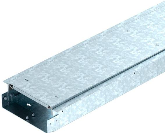
Montagefertige Kanaleinheit zur Leitungsführung, bestehend aus einem Kanalunterteil mit zwei Deckeln. Im Lieferumfang enthalten sind zwei Deckelstoßdichtungen und ein Verbinder. Zur Höheneinstellung werden sechs Nivelliereinheiten benötigt. Bis maximal 5 kN belastbar. Die Kanaleinheit kann mit ein verstellbaren Bodenbelagsanlegeprofil zur Estrichabgrenzung in Bereichen von Türlaibungen und vor Heizkörpernischen ergänzt werden.
