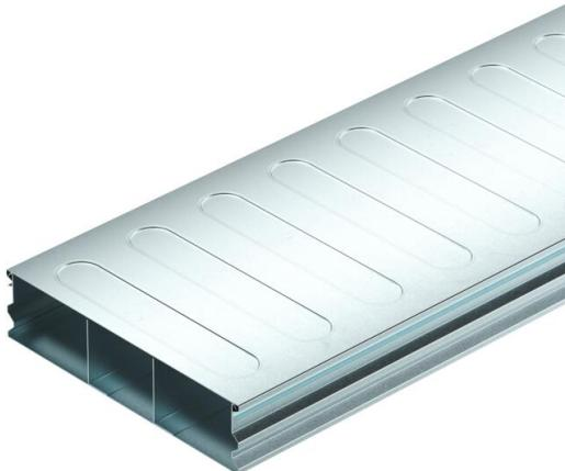
Unterflurkanal (2-teilig) zur Verlegung von Kabeln und Leitungen in estrichüberdeckten Unterflur-Systemen nach EN 50085-2-2. Abnehmbarer und durchgängig aufrastbarer Kanaldeckel. Mit Trennsteg im Kanalunterteil. Maximale Belastbarkeit bis 1,5 kN. Nur mit der UZD250-4/350-4 kompatibel. Die profilierten Seitenwände bieten eine Rastfunktion, um den Kanaldeckel auf das Kanalunterteil zu rasten. Die Versteifungssicken im Kanaldeckel dienen zur Stabilisierung.
