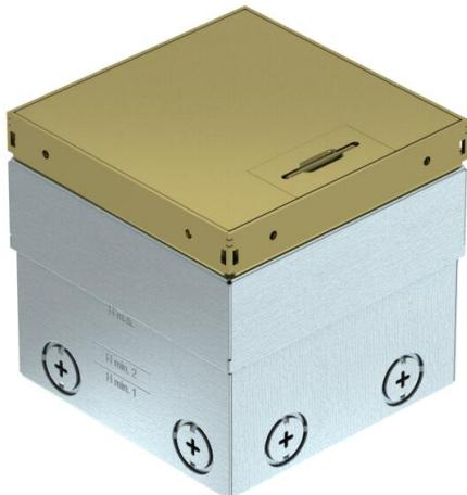
Quadratische Bodensteckdose für den Einsatz in trocken gepflegten Hohlböden und Estrichböden. Einbaugehäuse mit vorgeprägten Einführungsöffnungen für Rohre (M20/M25). Oberteil durch 4 Nivellierstützen auf Oberkante Bodenbelag einstellbar. Die Mindesteinbautiefe beträgt 100 mm, der Nivellierbereich + 35 mm.
