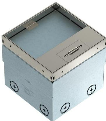
Quadratische Bodensteckdose für den Einsatz in trocken gepflegten Hohlböden und Estrichböden im Innenbereich. Einbaugehäuse mit vorgeprägten Einführungsöffnungen für Rohre (M20/M25). Oberteil durch 4 Nivellierstützen auf Oberkante Bodenbelag einstellbar. Die Mindesteinbautiefe beträgt 110 mm, der Nivellierungsbereich + 25 mm.
