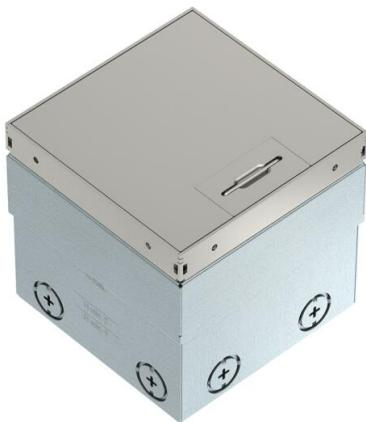
Quadratische Bodensteckdose für den Einsatz in trocken gepflegten Hohlböden und Estrichböden im Innenbereich. Einbaugehäuse mit vorgeprägten Einführungsöffnungen für Rohre (M20/M25). Oberteil durch 4 Nivellierstützen auf Oberkante Bodenbelag einstellbar. Die Mindesteinbautiefe beträgt 100 mm, der Nivellierungsbereich + 35 mm.
