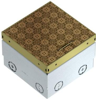
Quadratische Bodensteckdose für den Einsatz in trocken gepflegten Hohlböden und Estrichböden. Einbaugehäuse mit vorgeprägten Einführungsöffnungen für Rohre (M20/M25). Oberteil durch 4 Nivellierstützen auf Oberkante Bodenbelag einstellbar. Die Mindesteinbautiefe beträgt 100 mm, der Nivellierungsbereich + 35 mm.
