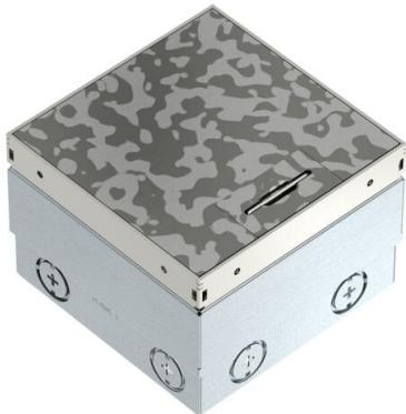
Quadratische Bodensteckdose für den Einsatz in trocken gepflegten Hohlböden und Estrichböden im Innenbereich. Einbaugehäuse mit vorgeprägten Einführungsöffnungen für Rohre (M20/M25). Oberteil durch 4 Nivellierstützen auf Oberkante Bodenbelag einstellbar. Die Mindesteinbautiefe beträgt 100 mm, der Nivellierungsbereich + 35 mm.
