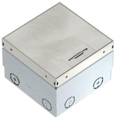
Quadratische Bodensteckdose für den Einsatz in trocken gepflegten Hohlböden und Estrichböden im Innenbereich. Einbaugehäuse mit vorgeprägten Einführungsöffnungen für Rohre (M20/M25). Oberteil durch 4 Nivellierstützen auf Oberkante Bodenbelag einstellbar. Die Mindesteinbautiefe beträgt 100 mm, der Nivellierbereich + 35 mm.
