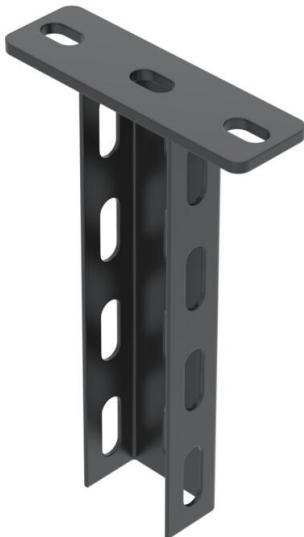
Hängestiel (U-Profil) in der Abmessung 50 x 30 mm mit angeschweißter Kopfplatte. Zur Befestigung an waagerechten Betondecken und Stahlträgern. Pulverbeschichtet in tiefschwarz (RAL 9005). Ab der Auslegerbreite 400mm oder der Montage des Auslegers am Ende des Hängestieles empfiehlt sich der Einsatz des Distanzstücks Typ DSK 25.
