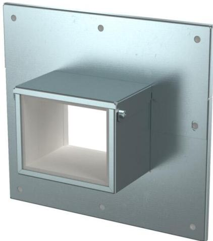
Wandanschlusskragen, 4-seitig mit integrierter Dichtung für Installationskanal PYROLINE® Rapid PLM. Zur Montage im Bereich von Wand- und Deckenanschlüssen sowie Wanddurchführungen. Auch als 3-seitiger Wandanschlusskragen bei direkter Wand- oder Deckenmontage des Kanals einsetzbar. Kein elektrischer Funktionserhalt nach DIN 4102 Teil 12!
