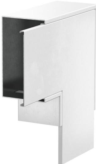
Flachwinkel mit intumeszierendem Brandschutzwolle für Installationskanal PY-ROLINE® Rapid PLM. Geeignet für die direkte Wand- und Deckenmontage, Montage unterhalb von Systemböden und auf Tragsystemen. Werkzeuglose Stoßstellenmontage mit Stoßstellenverbinde PLM SI. Der Deckel wird werkzeuglos aufgerastet und ermöglicht eine schnelle Revision und Nachbelegung. Deckelüberstand ermöglicht versetzte Deckelmontage für durchgängigen Potentiausgleich der gesamten Kanalstrecke.
