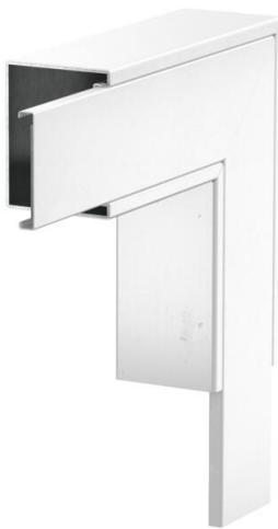
Flachwinkel mit intumeszierendem Brandschutzwolle für Installationskanal PY-ROLINE® Rapid PLM. Geeignet für die direkte Wand- und Deckenmontage, Montage unterhalb von Systemböden und auf Tragsystemen. Werkzeuglose Stoßstellenmontage mit Stoßstellenverbinde PLM SI. Der Deckel wird werkzeuglos aufgerastet und ermöglicht eine schnelle Revision und Nachbelegung. Deckelüberstand ermöglicht versetzte Deckelmontage für durchgängigen Potentiausgleich der gesamten Kanalstrecke.
