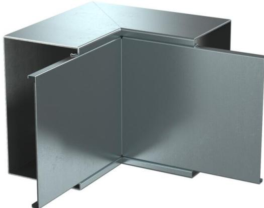
Inneneck mit intumeszierendem Brandschutzgewebe für Installationskanal PY-ROLINE® Rapid PLM. Geeignet für die direkte Wand- und Deckenmontage, Montage unterhalb von Systemböden und auf Tragsystemen. Werkzeuglose Stoßstellenmontage mit Stoßstellenverbinde PLM SI. Der Deckel wird werkzeuglos aufgerastet und ermöglicht eine schnelle Revision und Nachbelegung. Deckelüberstand ermöglicht versetzte Deckelmontage für durchgängigen Potentialausgleich der gesamten Kanalstrecke.
