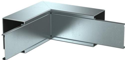
Inneneck mit intumeszierendem Brandschutzgewebe für Installationskanal PY-ROLINE® Rapid PLM. Geeignet für die direkte Wand- und Deckenmontage, Montage unterhalb von Systemböden und auf Tragsystemen. Werkzeuglose Stoßstellenmontage mit Stoßstellenverbinde PLM SI. Der Deckel wird werkzeuglos aufgerastet und ermöglicht eine schnelle Revision und Nachbelegung. Deckelüberstand ermöglicht versetzte Deckelmontage für durchgängigen Potentialausgleich der gesamten Kanalstrecke.
