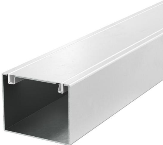
Installationskanal aus Metall mit intumeszierendem Brandschutzgewebe zur brandsicheren Verlegung von Kabeln. Klassifiziert als Installationskanal EI30, EI60 und EI90 gemäß EN 13501-2, geprüft nach EN 1366-5. Der Kanal verhindert über den klassifizierten Zeitraum die Brandweiterleitung und schützt vor den Auswirkungen eines Kabelbrandes.
