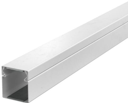
Installationskanal aus Metall mit intumeszierendem Brandschutzgewebe zur brandsicheren Verlegung von Kabeln. Klassifiziert als Installationskanal EI30, EI60 und EI90 gemäß EN 13501-2, geprüft nach EN 1366-5. Der Kanal verhindert über den klassifizierten Zeitraum die Brandweiterleitung und schützt vor den Auswirkungen eines Kabelbrandes.
