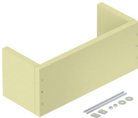
Zugentlastung als wirksame Unterstützungsmaßnahme für senkrechte Kabelverlegung nach DIN 4102 Teil 12. Zugelassen für alle Kabeltypen und Verlegesysteme, die direkt an Massivwänden montiert werden. Funktionserhaltklassen E30 bis E90. Leeres Gehäuse zur individuellen Füllung mit Brandschutzschaum PYROSLIT® NG und/oder Schaumstoffblöcken PYROPLUG® Block, inkl. Montageset und Kennzeichnungsschild.
