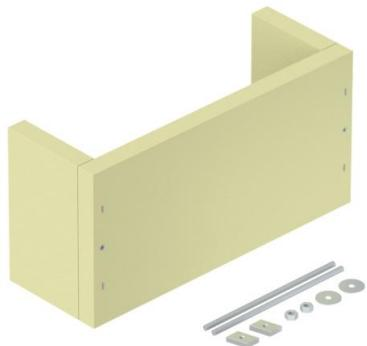
Zugentlastung als wirksame Unterstützungsmaßnahme für senkrechte Kabelverlegung nach DIN 4102 Teil 12. Zugelassen für alle Kabeltypen und Verlegesysteme, die direkt an Massivwänden montiert werden. Funktionserhaltklassen E30 bis E90. Leeres Gehäuse zur individuellen Füllung mit Brandschutzschaum PYROSLIT® NG und/oder Schaumstoffblöcken PYROPLUG® Block, inkl. Montageset und Kennzeichnungsschild.
