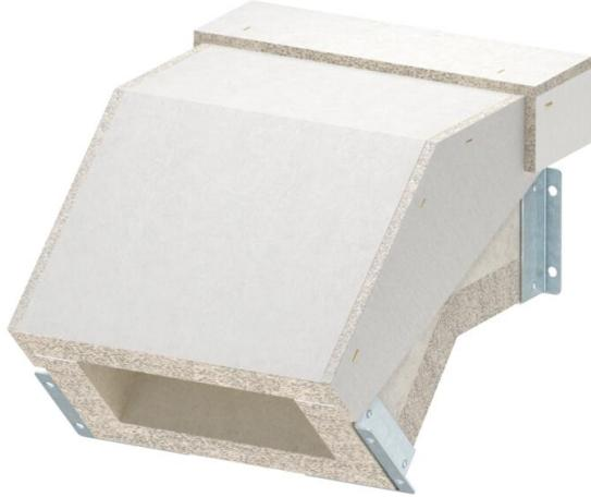
Vertikalbogen fallend für Brandschutzkanal PYROLINE® Con S, Typ BSKH09-K1021 bestehend aus wasser- und frostbeständigen Glasfaserleichtbeton zur Herstellung von vertikalen Richtungsänderungen (45°) im Kanalverlauf. Fertig montierte Verbindungsbeschläge sorgen für eine schnelle Montage vor Ort, lose aufgelegte Deckel für eine schnelle Revision und Nachbelegung. Inklusive Verbindungsschrauben und Dichtungsstreifen. Inklusive Verbindungsschrauben und Dichtungsstreifen.
