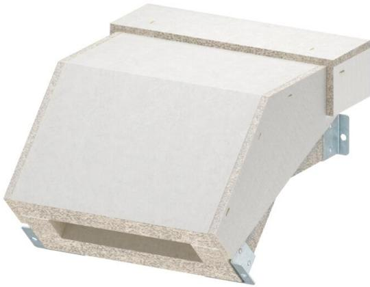
Vertikalbogen fallend für Brandschutzkanal PYROLINE® Con S, Typ BSKH09-K0521 bestehend aus wasser- und frostbeständigen Glasfaserleichtbeton zur Herstellung von vertikalen Richtungsänderungen ( $45^\circ$ ) im Kanalverlauf. Fertig montierte Verbindungsbeschläge sorgen für eine schnelle Montage vor Ort, lose aufgelegte Deckel für eine schnelle Revision und Nachbelegung. Inklusive Verbindungsschrauben und Dichtungsstreifen.
