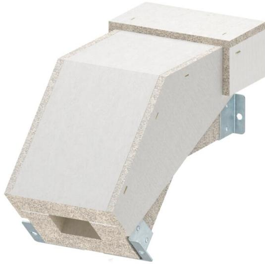
Vertikalbogen fallend für Brandschutzkanal PYROLINE® Con S, Typ BSKH09-K0506 bestehend aus wasser- und frostbeständigen Glasfaserleichtbeton zur Herstellung von vertikalen Richtungsänderungen (45°) im Kanalverlauf. Fertig montierte Verbindungsbeschläge sorgen für eine schnelle Montage vor Ort, lose aufgelegte Deckel für eine schnelle Revision und Nachbelegung. Inklusive Verbindungsschrauben und Dichtungsstreifen. Inklusive Verbindungsschrauben und Dichtungsstreifen.
