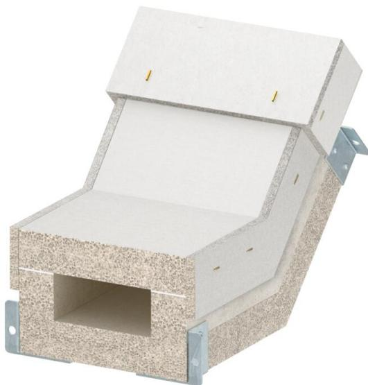
Vertikalbogen steigend für Brandschutzkanal PYROLINE® Con S, Typ BSKH09-K0511 bestehend aus wasser- und frostbeständigen Glasfaserleichtbeton zur Herstellung von vertikalen Richtungsänderungen ( $45^\circ$ ) im Kanalverlauf. Fertig montierte Verbindungsbeschläge sorgen für eine schnelle Montage vor Ort, lose aufgelegte Deckel für eine schnelle Revision und Nachbelegung. Inklusive Verbindungsschrauben und Dichtungsstreifen.
