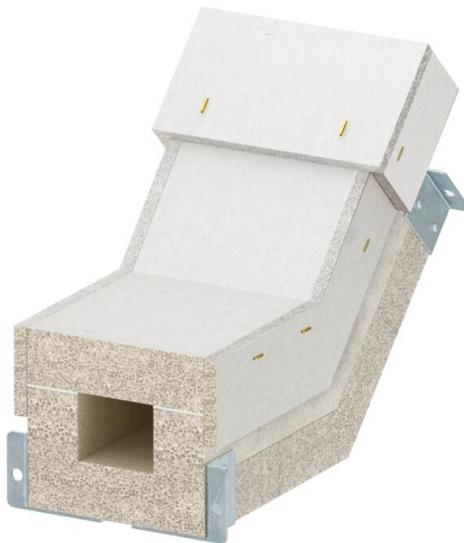
Vertikalbogen steigend für Brandschutzkanal PYROLINE® Con S, Typ BSKH09-K0506 bestehend aus wasser- und frostbeständigen Glasfaserleichtbeton zur Herstellung von vertikalen Richtungsänderungen (45°) im Kanalverlauf. Fertig montierte Verbindungsbeschläge sorgen für eine schnelle Montage vor Ort, lose aufgelegte Deckel für eine schnelle Revision und Nachbelegung. Inklusive Verbindungsschrauben und Dichtungsstreifen. Inklusive Verbindungsschrauben und Dichtungsstreifen.
