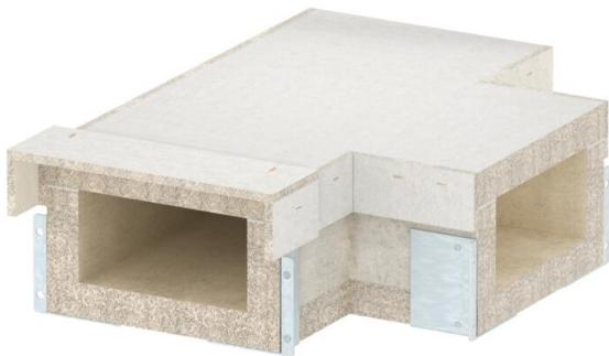
T-Stück für Brandschutzkanal PYROLINE® Con S, Typ BSKH09-K1021 bestehend aus wasser- und frostbeständigen Glasfaserleichtbeton zur Herstellung von T-Abzweigungen im Kanalverlauf. Fertig montierte Verbindungsbeschläge sorgen für eine schnelle Montage vor Ort, lose aufgelegte Deckel für eine schnelle Revision und Nachbelegung.
