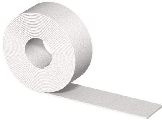
Selbstklebender Dichtungsstreifen zur Montage in den Stoßfugen der einzelnen Kanalstücke und für die Abdichtung zwischen Unterteil und Deckel der Brandschutzkanäle PYROLINE® CON D BSK I90/E30 und PLC EI30 - EI60 sowie PYROLINE® CON S BSK I90/E30
