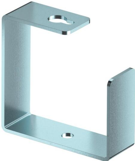
Trennbügel als Installationshilfe zur Kabelverlegung bei Deckenmontage des Brandschutzenkanals Typ BSKD09-1021 und Typ BSKD12-K1021. Montage des Bügels direkt an den Befestigungsdübeln des Brandschutzenkanals.
