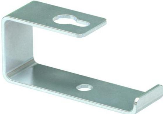
Trennbügel als Installationshilfe bei Deckenmontage des Brandschutzkanals PY-ROLINE® Con D BSK, Typ BSK 090511 und Typ BSK 120511. Montage des Bügels direkt an den Befestigungsdübeln des Brandschutzkanals.
