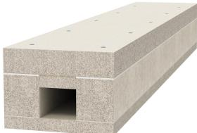
Brandschutzkanal aus wasser- und frostbeständigen Glasfaserleichtbeton der Baustoffklasse A1 gemäß EN 13501-1 zur brandsicheren Verlegung von Kabeln in Flucht- und Rettungswegen und zum Funktionserhalt sicherheitsrelevanter Anlagen. Klassifizierung I120 als I-Kanal gemäß DIN 4102 Teil 11 und Klassifizierung E90 als E-Kanal gemäß DIN 4102 Teil 12.
