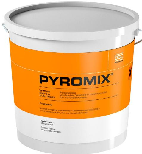
Mörtel zum Erstellen von Kabel- und Kombiabschottungen in massiven Wänden und Decken. Geeignet zum Pumpen, Pressen und zum Handeinbau. 10 kg Trockenmörtel ergeben bei Zugabe von ca. 3 Litern Wasser etwa 10 Liter verarbeitungsfähige Masse. Anwendung im Innernbereich.
