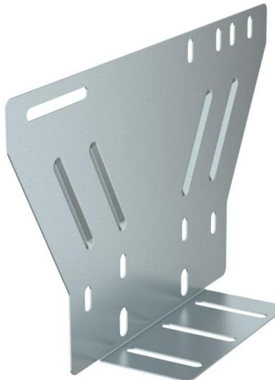
Universelle Montageplatte zur Befestigung der FireBox T-Serie an der Rückseite von Kabel- und Gitterrinnen sowie Kabelleitern mit max. 60 mm Seitenhöhe. Er-möglicht die sichere Montage der Funktionserhaltakabel, ohne diese über den Seitenholm biegen zu müssen. Passend für alle FireBoxen.
