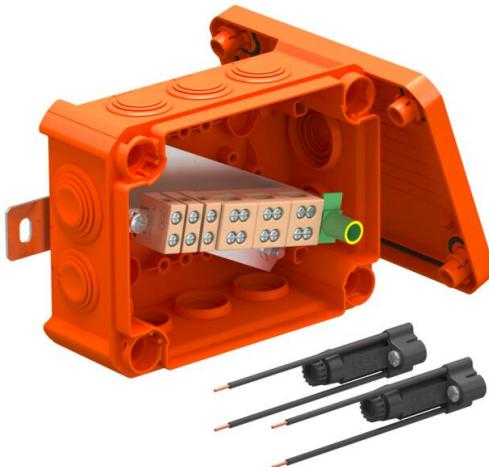
Kabelabzweigkasten mit zwei Sicherungshaltern und weichen Einstechdichtungen. Ausreichender Verdrahtungsraum durch diagonal angeordnete Anschluss-einheit mit komplett vormontierten hochtemperaturbeständigen Keramikklem-men. Grün-gelb gekennzeichnete Schutzleiterklemme. Befestigung an gut zu-gänglichen Außenlaschen. Zugelassen für Kabelanlagen mit elektrischem Funkti-onserhalt nach DIN 4102 Teil 12 mit den Klassen E30, E60 und E90. Keramik-klemmen wurden nach DIN EN 60998-2-1:2004 geprüft.
