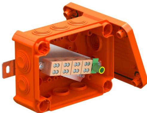
Kabelabzweigkasten mit keramischen Doppelklemmen und weichen Einstektdichtungen. Ausreichender Verdrahtungsraum durch diagonal angeordnete Anschlussseinheit mit komplett vormontierten hochtemperaturbeständigen Keramikklemmen. Grün-gelb gekennzeichnete Schutzleiterklemme. Befestigung an gut zugänglichen Außenlaschen. Zugelassen für Kabelanlagen mit elektrischem Funktionserhalt nach DIN 4102 Teil 12 mit den Klassen E30, E60 und E90. Keramikklemmen wurden nach DIN EN 60998-2-1:2004 geprüft.
