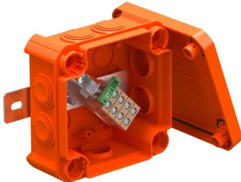
Kabelabzweigkasten mit keramischen Einzelklemmen und weichen Einstektdichtungen. Ausreichender Verdrahtungsraum durch diagonal angeordnete Anschlusseinheit mit komplett vormontierten hochtemperaturbeständigen Keramikklemmen. Grün-Gelb gekennzeichnete Schutzleiterklemme. Befestigung an gut zugänglichen Außenlaschen. Zugelassen für Kabelanlagen mit elektrischem Funktionserhalt nach DIN 4102 Teil 12 mit den Klassen E30, E60 und E90. Keramikklemmen wurden nach DIN EN 60998-2-1:2004 geprüft.
