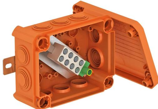
Halogenfreier Kabelabzweigkasten mit vormontierten, weichen Einstechdichtungen, zugelassen für den elektrischen Funktionserhalt gemäß DIN 4102 Teil 12. Funktionserhaltklassen E30 bis E90.
