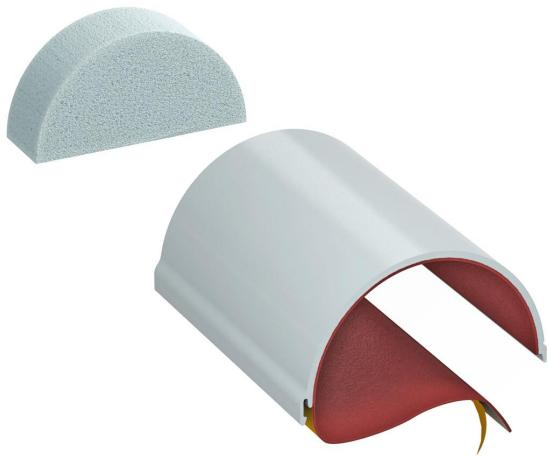
Innenbeschichtete Halbschale, die im Innenraum vollständig mit Kabeln und Elektroinstallationsrohren belegt werden kann. Anwendung im Innenbereich. CE-gekennzeichnetes, europäisch zugelassenes Bauprodukt gemäß ETA-13/0904 und deutscher allgemeiner Bauartgenehmigung. Feuerwiderstand bis 120 Minuten.
