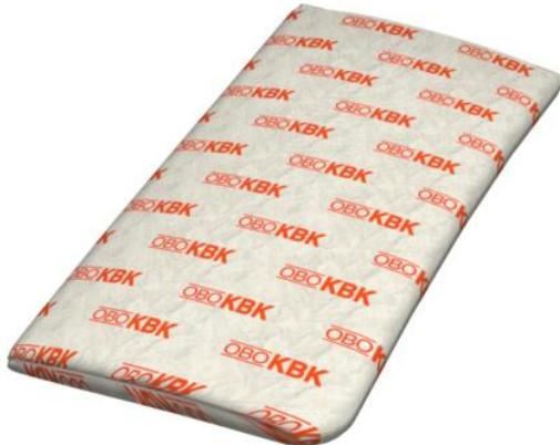
Kabel-Brandschutzkissen aus engmaschigem, dichtem und mechanisch festem Glasgewebe mit Spezialfüllung. Frei von Mineralfasern, witterfest und wasserunempfindlich. Anwendung im Innenbereich.
