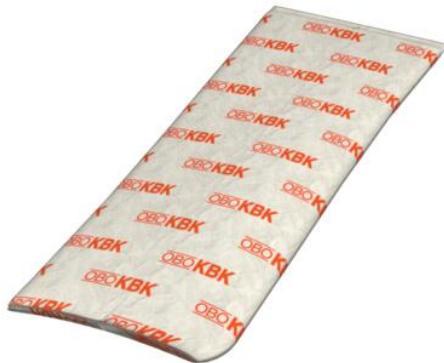
Kabel-Brandschutzkissen aus engmaschigem, dichtem und mechanisch festem Glasgewebe mit Spezialfüllung. Frei von Mineralfasern, witterfest und wasserunempfindlich. Anwendung im Innenbereich.
