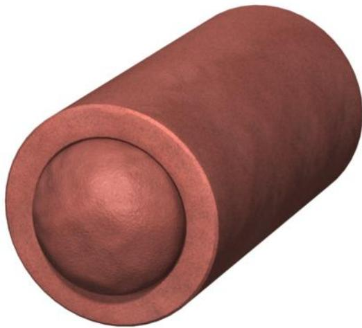
Rohrschale für Kabelschott bestehend aus einer einteiligen, harten Rohrhülse und zwei weichen Stopfen mit 50 mm Durchmesser. Rohrhülse und Stopfen vor Wasser schützen, um ein sicheres Aufschäumen im Brandfall zu garantieren. Anwendung im Innenbereich.
