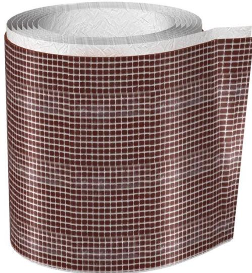
Selbstklebender, intumeszierender Kabelwickel, 5 mm dick, zum Einsatz bei großen Kabeldurchmessern und zur Anwendung auf durchgeführten Kabeltrag-Systemen; einsetzbar in den PYROPLUG® Systemen und PYROSIT® NG. Anwendung im Innenbereich.
