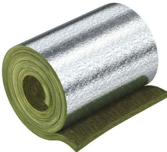
Mineralwolleplatten mit Aluminiumkaschierung für Streckenisolierungen für Kupfer- und Stahlrohren. Befestigung der Streckenisolierung mit Wickeldraht und sichern der Stoßfugen mit Aluminiumklebeband.
