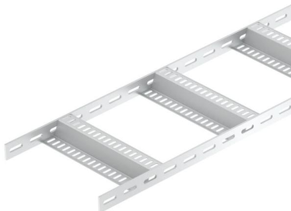
Schiffbau-Kabelleiter mit gelochtem Seitenholm in der Seitenhöhe 40 mm mit eingeschweißten, gelochten Z-Sprossen.
