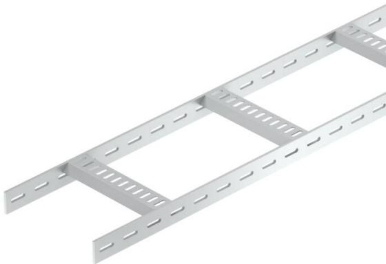
Schiffbau-Kabelleiter mit gelochtem Seitenholm in der Seitenhöhe 40 mm mit eingeschweißten, nach unten offenen und gelochten Trapezsprossen.
