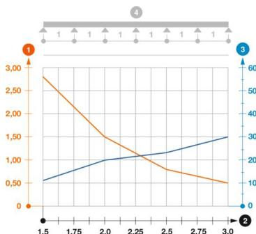
Belastungsdiagramm Kabelleiter Typ SLZ A2 A4
